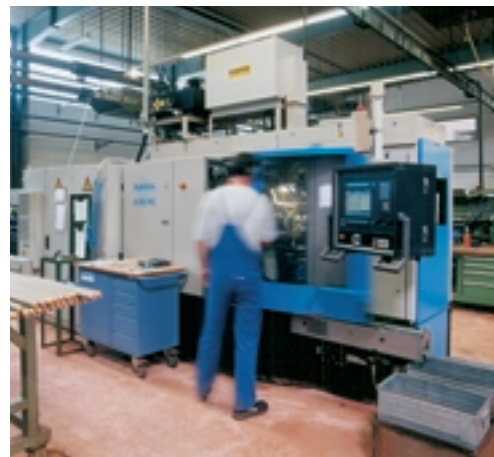
Investitionen prägten das Berichtsjahr bei Franz Funke. Auf diesem CNC-gesteuerten 6-Spindel-Drehautomaten werden Präzisionsteile u.a. für die Automobilindustrie produziert.
